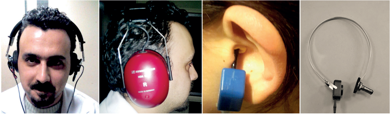
Şekil 3. Odyolojide sıklıkla kullanılan transdüser tipleri (soldan sağa sırasıyla; supraaural kulaklık, sirkumaural kulaklık, insert kulaklık, kemik vibratör)
