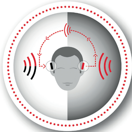
Resim 39. BiCROS işitme cihazı uygulaması (sol kulak hiç işitmeyen kulak, sağ kulak az işiten kulak) (13)
